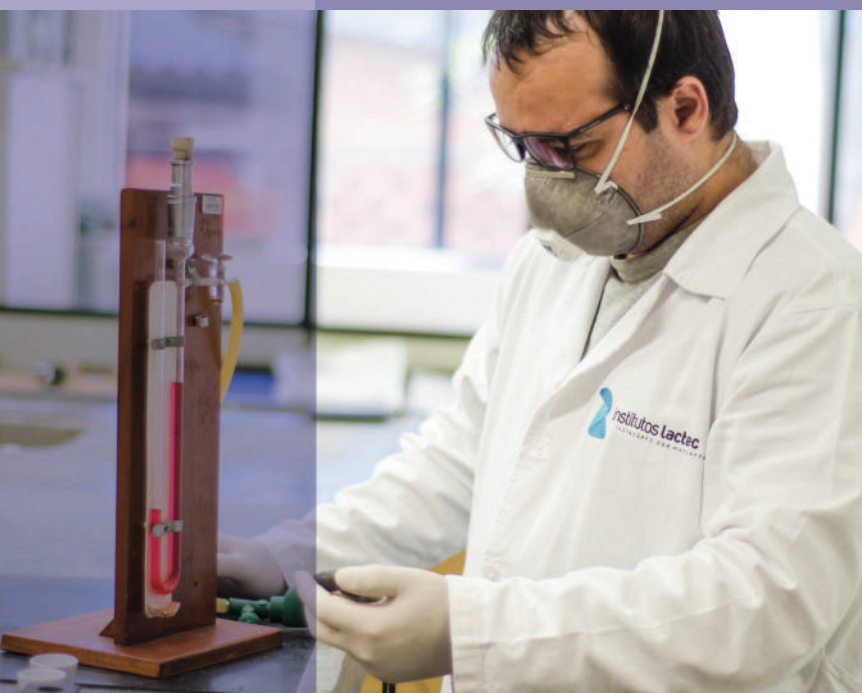
Permeabilidade Blaine em amostra de cimento
