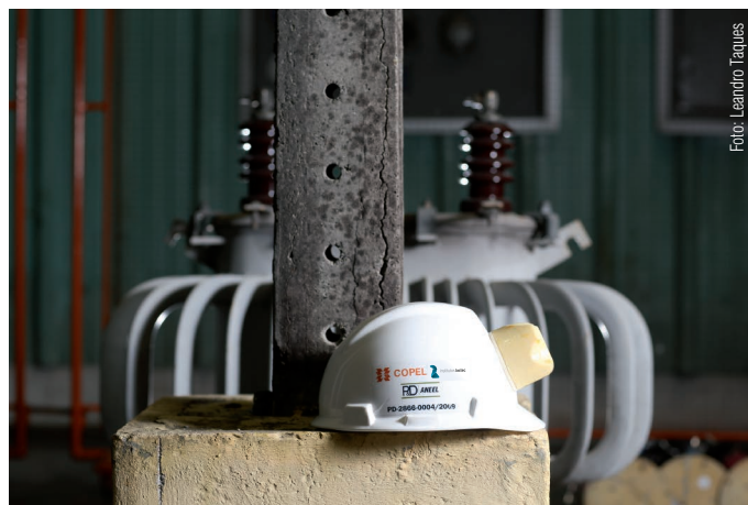
Capacete de segurança com sensor de proximidade de rede energizada
